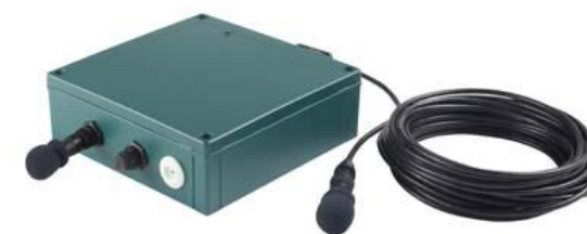
Photo 68 - Boîtier d'enregistrement à chiroptères de type SM2BAT+
