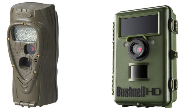
Photo 66 - Piège photographique Cuddeback Attack® à gauche et piège photographique Bushnell Natureview HD® à droite.
